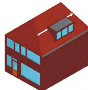
Bij schilddaken de kleinste afstand hanteren voor de plaatsing in het dakvlak
