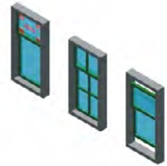
Oorspronkelijke kozijnen uit de bouwperiode van voor 1900
